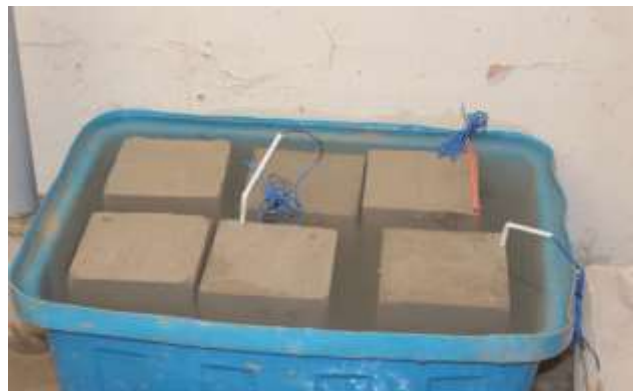
Hình 6: Công tác dưỡng hộ mẫu cột thí nghiệm
