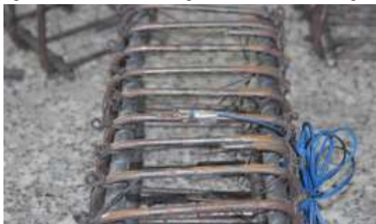
Hình 3: Cốt thép được gắn SG ở 3 loại đai s=50, 30 và 25
