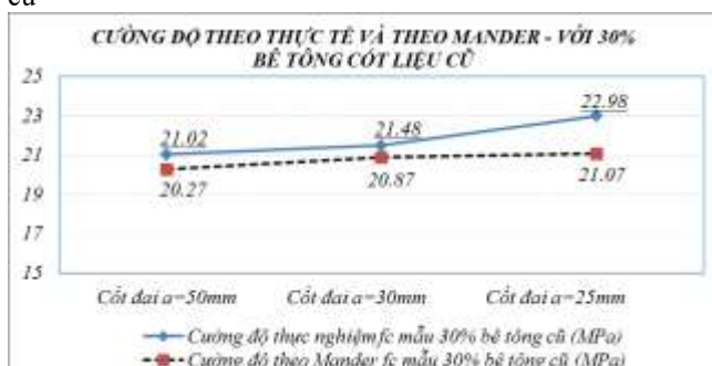
Hình 20: Biểu đồ thể hiện cường độ theo thực tế và theo Mander mẫu sử dụng 30% cốt liệu cũ
